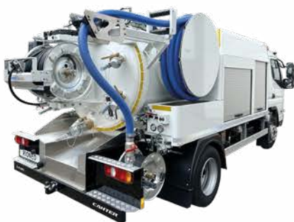
FlexCom na podwoziu Fuso Canter
